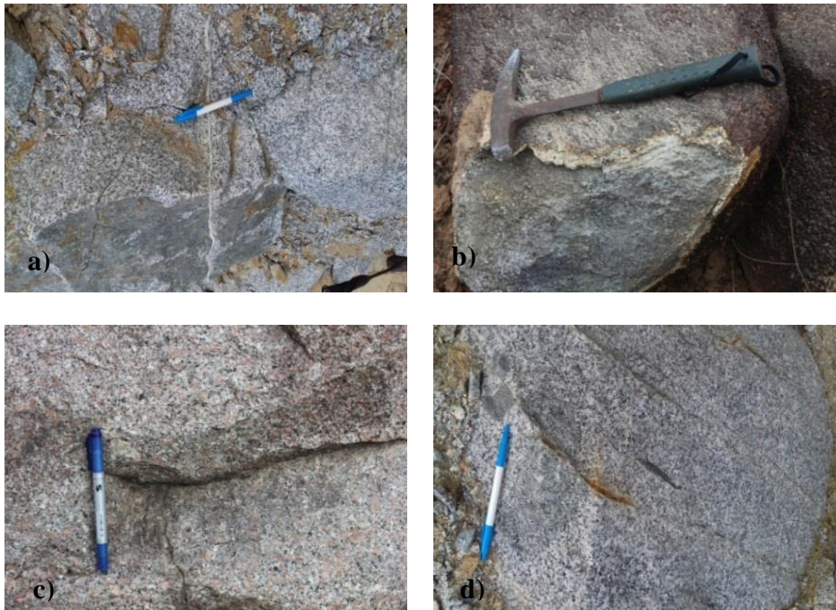
Hình 2. Ảnh mẫu cục của các đá xâm nhập phức hệ Bến Giàng và phức hệ Vân Canh, khu vực Sa Thầy: a) Đá granodiorit biotit (BG1); b) Đá diorit hornblend – biotit (BG2); c) Đá granit biotit hạt mịn – vừa (VC1); d) Đá granit biotit hạt mịn (VC2/1)
