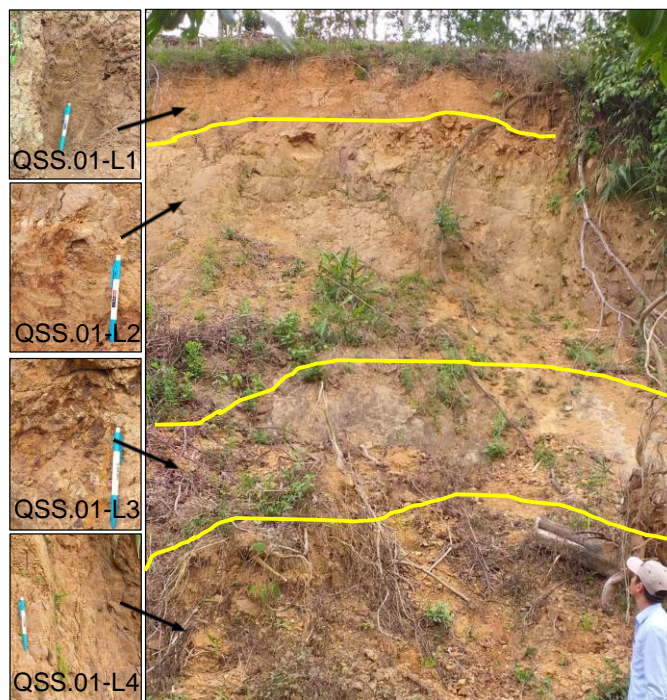
Hình 2a. Mặt cắt vỏ phong hoá QSS01 trên đá granodiorit phức hệ Bến Giằng – Quế Sơn ở Thượng Nhật
