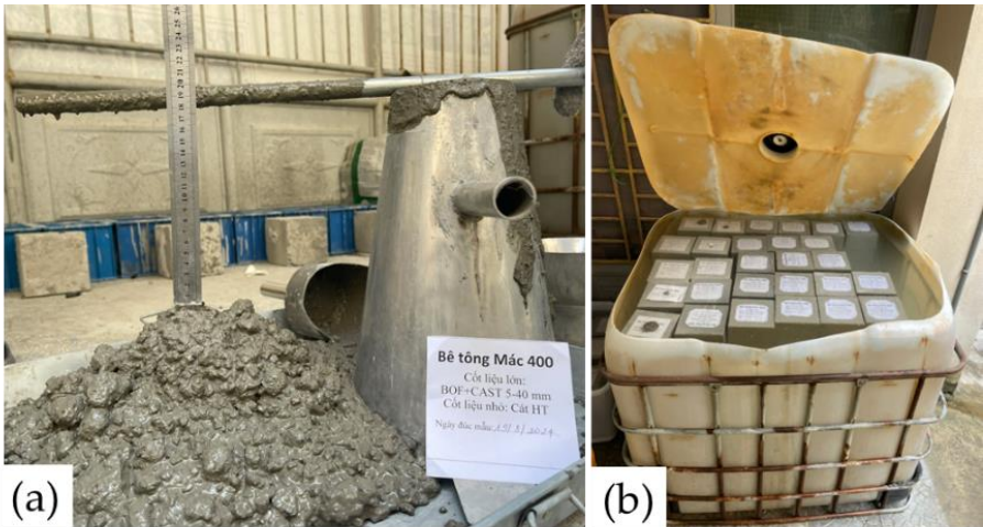
Hình 4. (a) Độ sụt của hỗn hợp bê tông tươi và (b) công tác bảo dưỡng mẫu trước khi thí nghiệm xác định cường độ chịu nén
