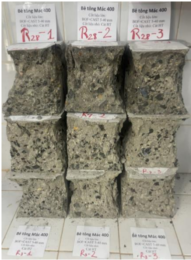
Hình 6. Mẫu bê tông sau khi thí nghiệm xác định cường độ chịu nén
